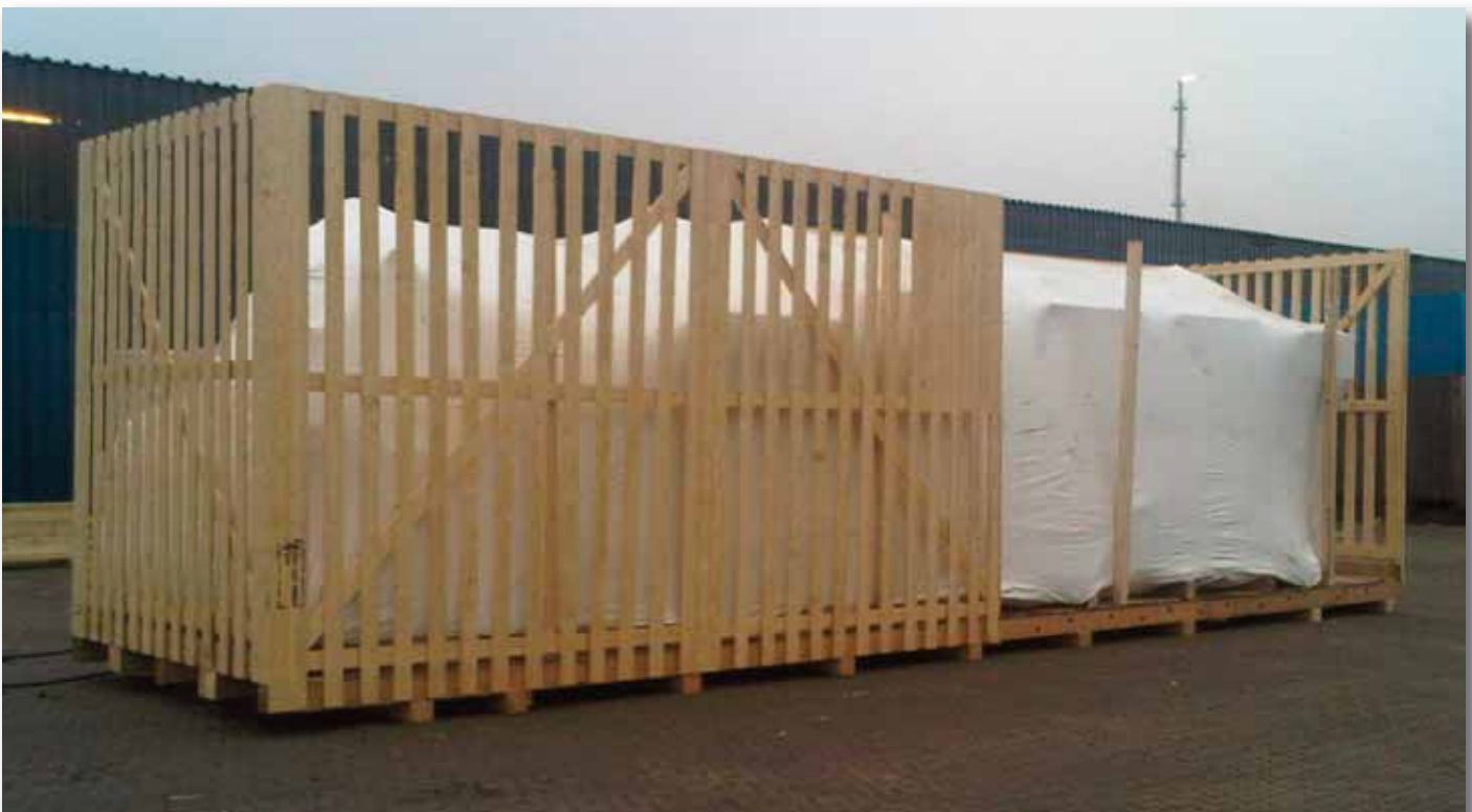
In VCI-Folie eingeschweißte Maschine auf Containerboden mit Holzverschlag. VOLLMERTs bevorzugte Verpackung beim Transport als „break-bulk“ im Schiffsbauch.
