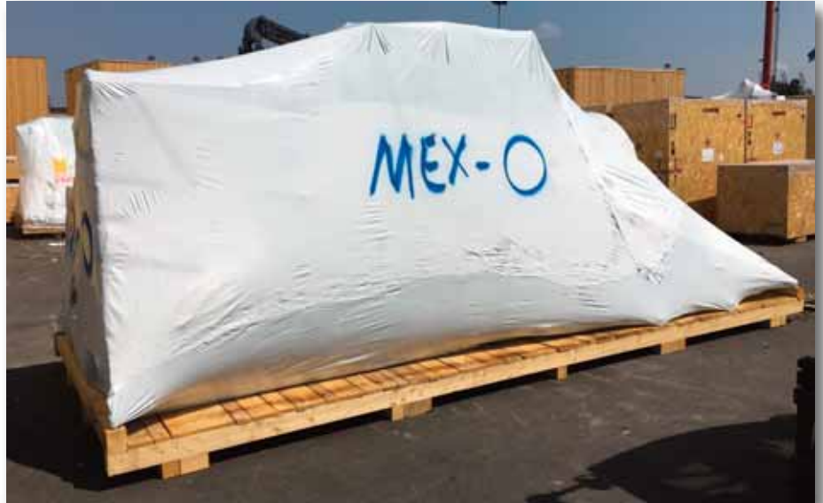
Gepackte, in VCI-Folie eingeschweißte Maschinenteile - fertig zum Stauen in einen Container.
