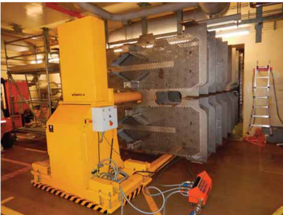
Eine auf Luftkissen verbaute Dreh-/Hebeeinrichtung zum Passieren von Engstellen.
