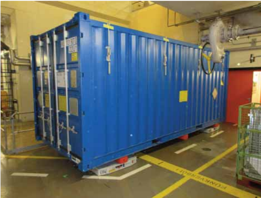
Rangieren eines mit Blei ausgeschlagenen Spezialcontainers mit zwei SFT40 und einem Rotationsfahrwerk.
