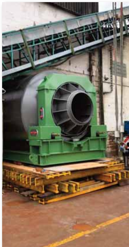
Mittels hydraulischem Zugsystem wird der Trommeltrockner behutsam verfahren.
