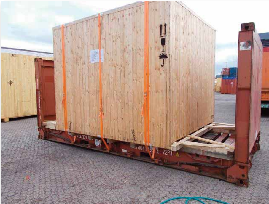
Fachmännisch gestaute und gelashte Transportkiste - fertig zum Transport mit dem Containererflat.
