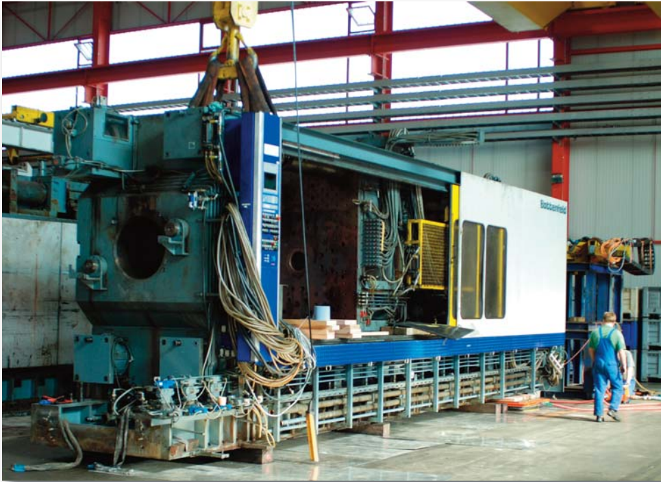
Gleich kann's losgehen: Die „Caster“ des Luftkissentransportsystems werden unterhalb einer Schließeinheit platziert
