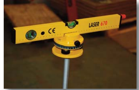
Laserwasserwaage zum Ermitteln der „Centerline“
